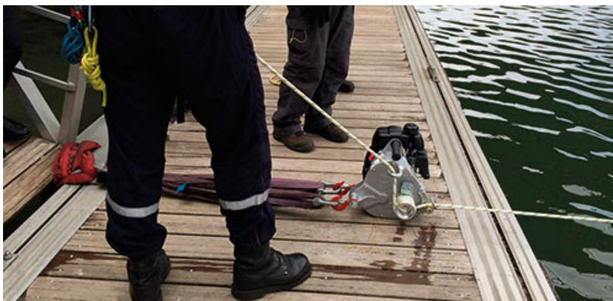
Le treuil portable peut être amené et ancré n'importe où.
